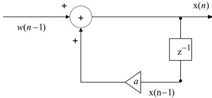
$w(n-1)$  - выборка белого шума;  $x(n)$  - случайный сигнал на выходе;  $z^{-1}$  - задержка на период дискретизации;  $a$  - коэффициент усиления;  $x(n-1)$  - выборка случайного сигнала с задержкой на период дискретизации
