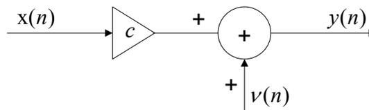
$x(n)$  - сигнал на входе после прохождения канала связи;  $c$  - коэффициент усиления;  $v(n)$  - белый шум;  $y(n)$  - сигнал на выходе
